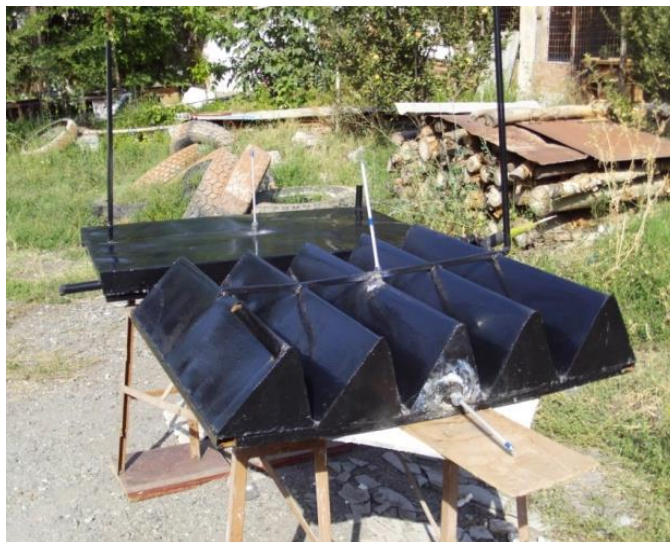
Рис.7. Общий вид мобильной солнечной водонагревательной установки (МСВУ) без полиэтиленовой пленки (на переднем плане)
